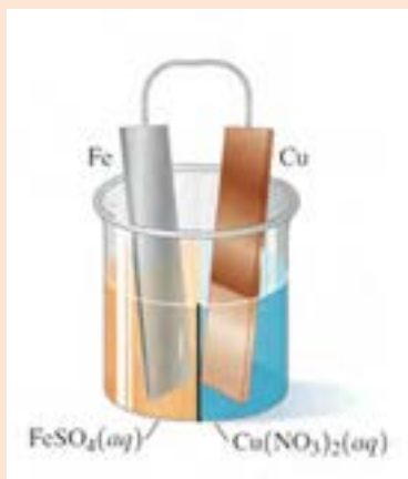
شکل ۵- سلول الکتروشیمیایی مس - آهن
